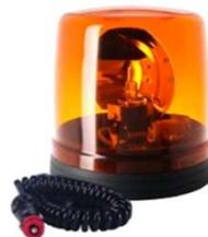
Die LBO-2000 ist durch Ihre kompakte und robuste Bauform für den Dauereinsatz von Sonderfahrzeugen konzipiert. Ihr Halogen Hochglanzreflektor mit langlebigem Metall-Schnecken Antrieb ist vibrationsgeschützt und seine H1 Birne leicht austauschbar.
