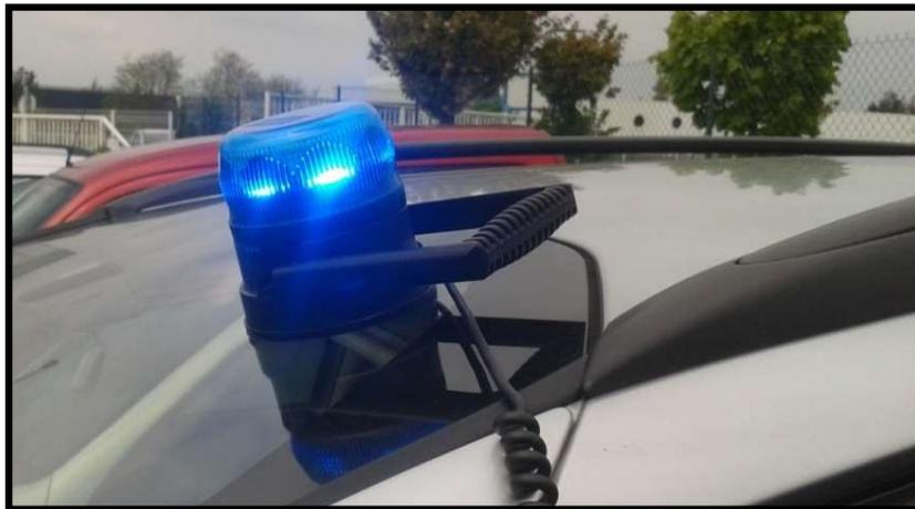
Die LBL Mercura LED ist durch Ihre kompakte und robuste Bauform für den Dauereinsatz von Sonderfahrzeugen konzipiert. LED's neuester Generation sorgen für eine hohe Lichtleistung und lange Lebensdauer. Ihre hohen Lichtwerte liegen über den geforderten und macht die LBL Mercura LED bei geringem Stromverbrauch, in allen Situationen zu einer optimalen Warnleuchte.
