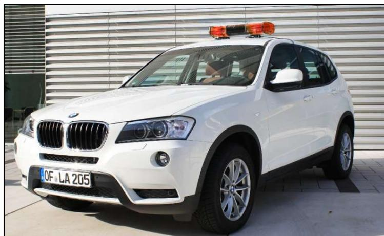
Die Warnbalken Serie LZP zeichnen sich durch ihre robuste und aerodynamische Bauform aus ohne an Warnwirkung zu verlieren. Breite **700** oder **1000** mm. Magnethalter auch für gewölbte Dächer, Kabel mit Stecker, Mikro für Sprachdurchsage.
