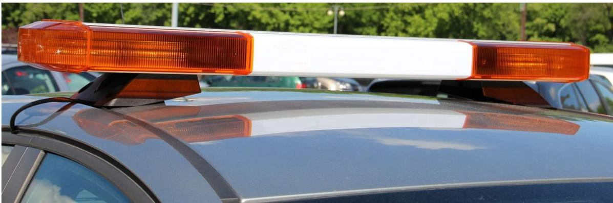
Die Warnbalken Serie **LZN-LED** zeichnet sich durch eine sehr flache und aerodynamische Bauform aus ohne an Warnwirkung zu verlieren. Breiten von 650 mm bis 2200 mm. Durch seine modulare Bauweise passt sich der LZN somit allen Anforderungen an. LED Module der neuesten Generation sorgen für eine noch bessere Signalwirkung bei geringem Stromverbrauch.
