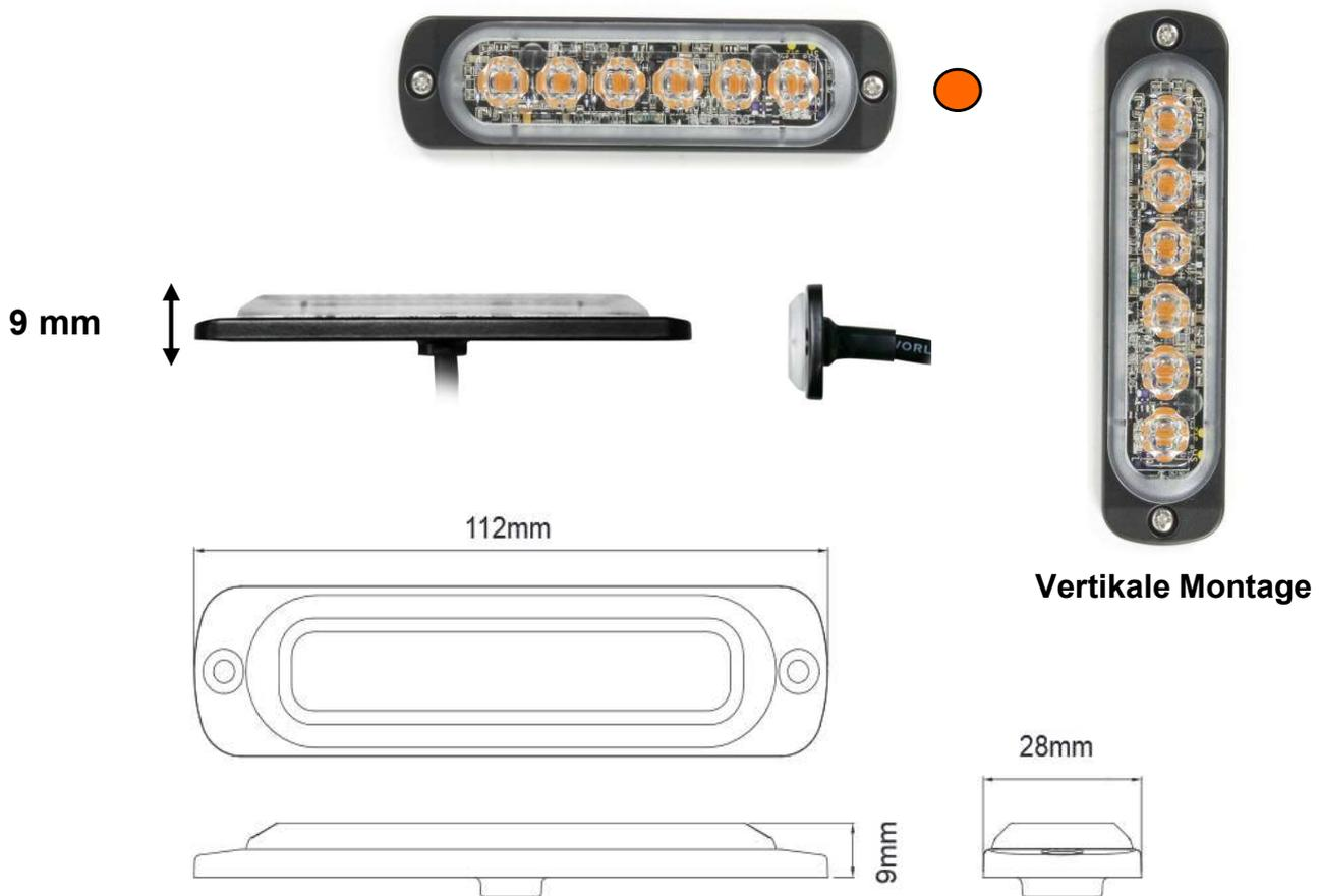
6 Hochleistungs- LED's pro Leuchtenkörper, LED's neuester Generation „Hohe Leuchtkraft“
