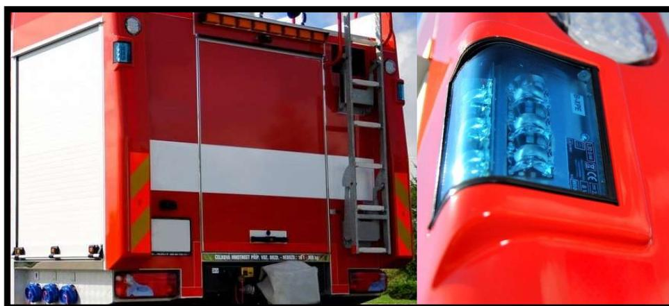
12 Hochleistungs- LED's pro Leuchtenkörper, LED's neuester Generation „Hohe Leuchtkraft“
