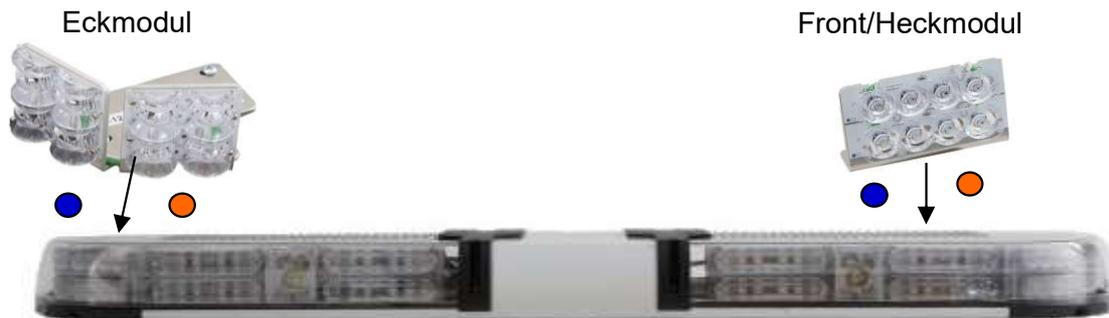
Die Warnbalken Serie Xpert-Double zeichnet sich durch eine sehr flache und aerodynamische Bauform aus ohne an Warnwirkung zu verlieren. Breiten von 430 mm bis 1900 mm. Durch seine modulare Bauweise passt sich der Xpert-Double somit allen Anforderungen an. Seine Blauen oder Gelben LED Module der neuesten Generation lassen sich getrennt schalten.
