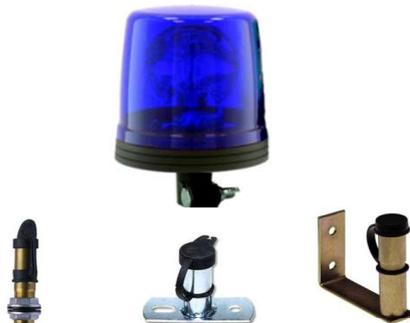
Die LBO-2000 ist durch ihre kompakte und robuste Bauform für den Dauereinsatz von Sonderfahrzeugen konzipiert. Ihr Halogen Hochglanzreflektor mit langlebigem Metall-Schnecken Antrieb ist vibrationsgeschützt und seine H1 Birne leicht austauschbar.
